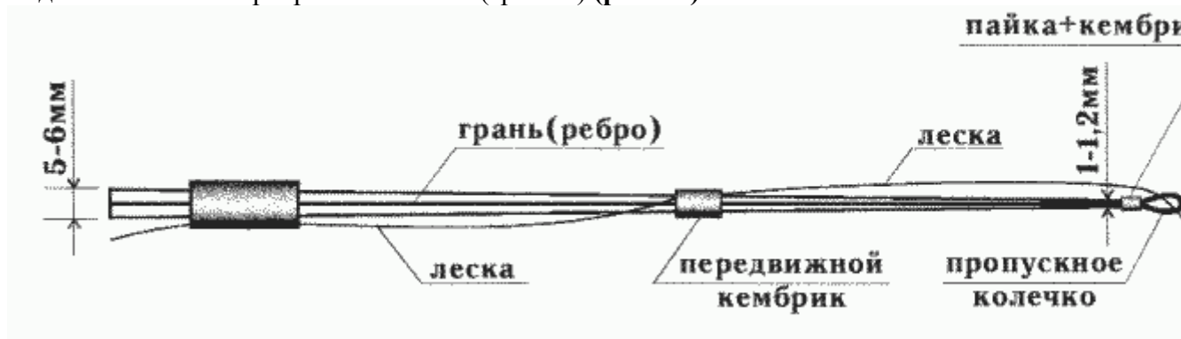
Рис. 37. Оснастка граненого кивка для ловли на безнасадочную мормышку
